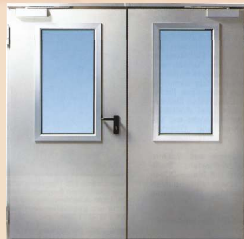
TAE-D T30 tűzgátló ajtó, 460x910 mm-es üvegezéssel. Az ajtócsukók és csukássorrendszabályozó széria tartozékok. A képen alumínium fedőleccel látható (külön rendelhető meg).
